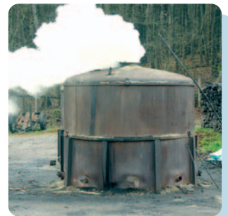
Stahlmeilers zur Holzkohlegewinnung
