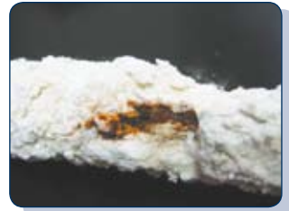
Verkalkte Opferanode aus einem Warmwasserspeicher
