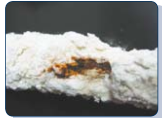
Verkalkte Opferanode aus einem Warmwasserspeicher
