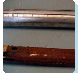
Abbildung G: Brunnenrohr ohne und mit Verockerung
