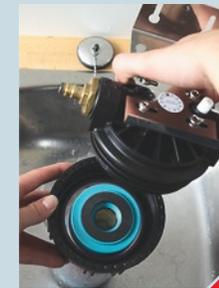
➤ Der Gehäusedeckel wird auf die Patrone in der Filtertasse gedrückt. **Wichtig:** Die Dichtung der Filterpatrone muss voll am Deckel anliegen. Erst dann kann das Gehäuse geschlossen werden. Dazu: Überwurfmutter mit dem Kunststoffschlüssel wieder anziehen.
