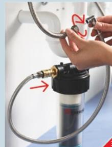
Nun den Wasserhahn an der Spüle schließen und das Filtergehäuse entlüften: Lappen auf das Entlüftungsventil (weiß) am Gehäusedeckel legen und mehrmals kurz auf den Knopf drücken, bis etwas Wasser austritt. Wasser rund fünf Minuten durch den Filter laufen lassen, um Filterpatrone zu aktivieren. Dabei kann etwas Kohlenstaub ausgespült werden. Dies ist normal und unbedenklich.
