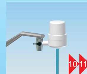
10 Das Gerät ist wieder einsatzbereit. Betätigung siehe Schritt 6. Neue Patronen sind ca. 5 Minuten zu spülen, um die Aktivkohle zu aktivieren. Dabei wird auch etwas Kohlestaub ausgespült. Dies ist normal und unbedenklich. Das Spülwasser bitte nicht verwenden.
