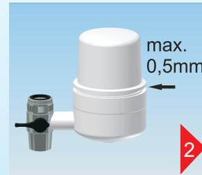
2 Zusammenschrauben, handfest anziehen (der Spalt zwischen Ober- und Unterteil darf max. 0,5 mm sein).
