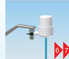
6 Durch Betätigung des Umschalthebels wechseln Sie zwischen Filter- und Normalwasser, neue Patronen sind zu spülen, siehe Schritt 10.
